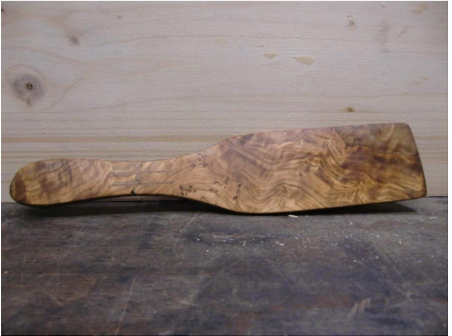
Olivenholz-Pfannenwender: War entzwei, mit eingesetzter Zapfenverbindung repariert.
